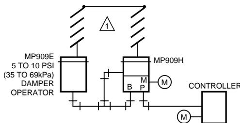
**1** SECTIONS OF A LARGE DAMPER REQUIRING MORE THAN ONE OPERATOR SHOULD BE PHYSICALLY LINKED WITH SLAVING OPERATORS. C2249
